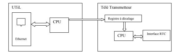
Aucune information ne peut être envoyée du transmetteur vers l'UTiL, en effet il n'existe aucune liaison dans ce sens.
